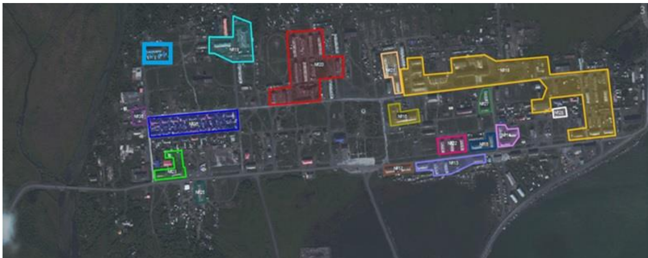
Рис. 2.1 - Зоны действия систем теплоснабжения микрорайона Новый поселок
